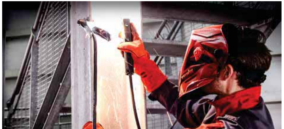
A lower average welding current makes the bath more viscous, less liquid, suitable for positional welding. - Una corrente di saldatura media più bassa rende il bagno più viscoso, meno liquido, adatto per la saldatura posizionale.
